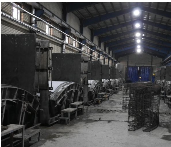
شکل ۹- نمایی از عملیات تولید سگمنت
