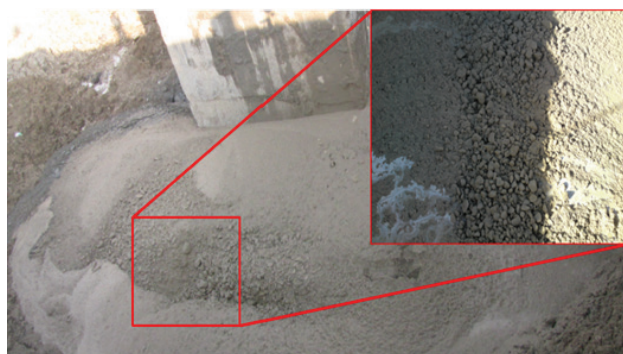
شکل ۵-نمایی از کوبل های حفاری شده توسط ماشین EPB-TBM در محل دمپ مصالح حفاری
