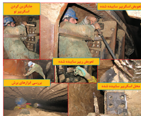
شکل ۱۹- عملیات تعویض ابزارهای برشی در داخل چمبر
