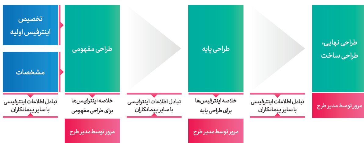
شکل ۳-فلوچارت نحوه مدیریت اینترفیس در قراردادهای طراحی
