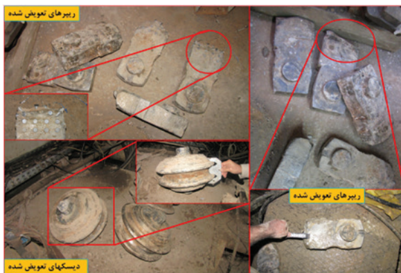
شکل ۲- ابزارهای برش تعویض شده در یک دوره
