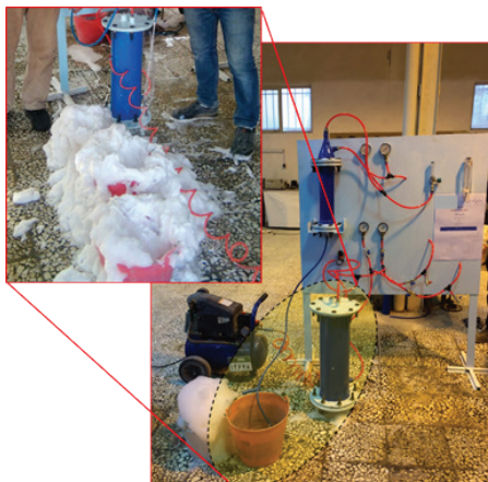
شکل ۳- دستگاه تولید فوم حفاری در مقیاس آزمایشگاه
