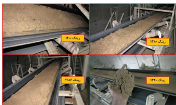
شکل ۶- مصالح عمل‌آوری شده بر روی نوار نقاله
