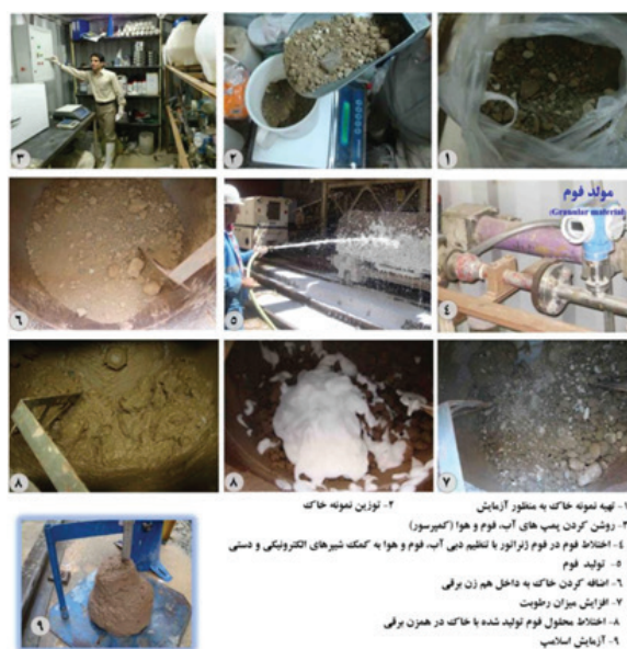
شکل ۵- مراحل انجام آزمایش عمل‌آوری مصالح
