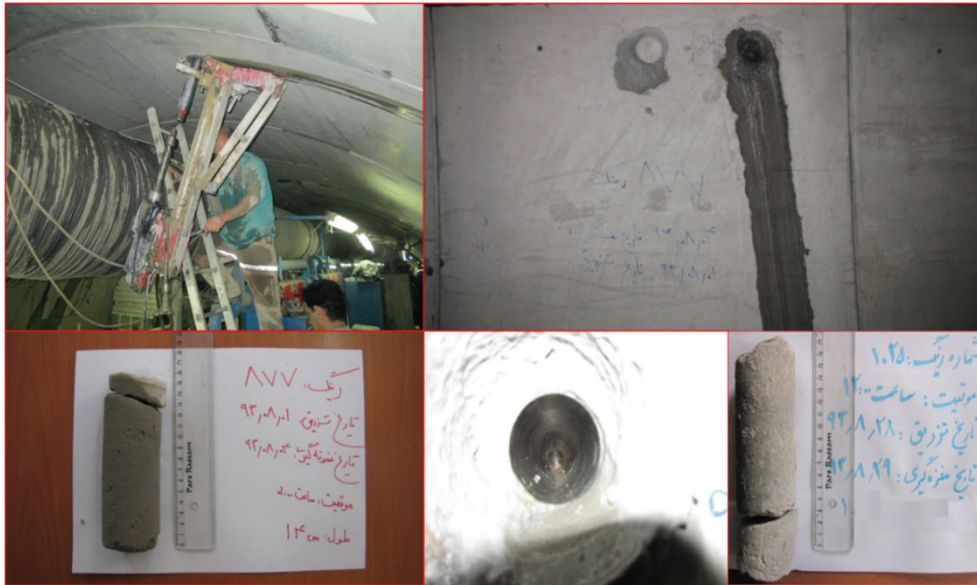
شکل ۲۰- نمایی از عملیات نمونه‌گیری از داخل سگمنت
