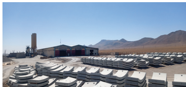
شکل ۵- نمایی از دیو سگمنت در کارخانه
