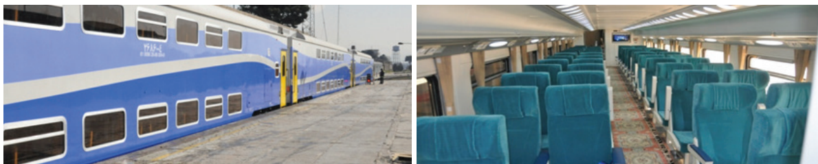
شکل ۸- قطار دوسر دو طبقه خط ۵ متروی تهران (Push-Pull) / طراحی شرکت چینی
