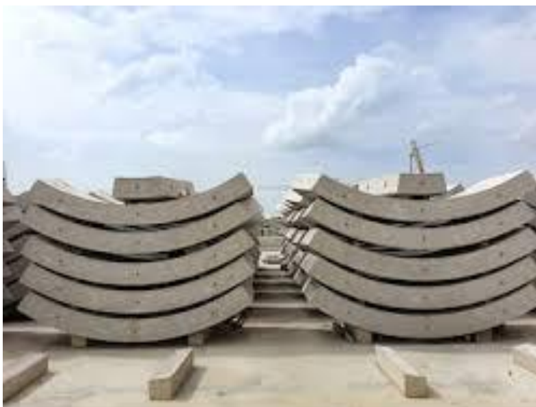
شکل ۲-۳: دپوی دائم سگمنت‌ها
