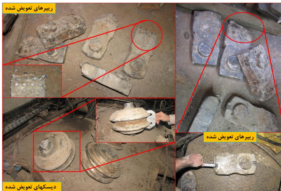
شکل ۲-۱۸: ابزارهای برش تعویض شده در یک دوره
