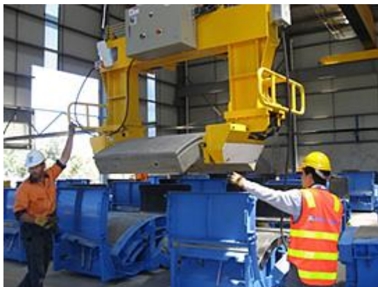
الف) خروج سگمنت از قالب بوسیله مکش
