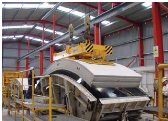
ب) خروج سگمنت از قالب بوسیله جک مکانیکی
